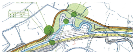
写真 4：山付部を保全し、片側を拡幅した区間。＊山附の河岸は蛇行しているため川幅は変化する。川幅の変化は川の作用に
