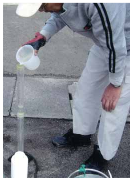
透視度の測定。 採水したら直ちに明るいところで測定する。
