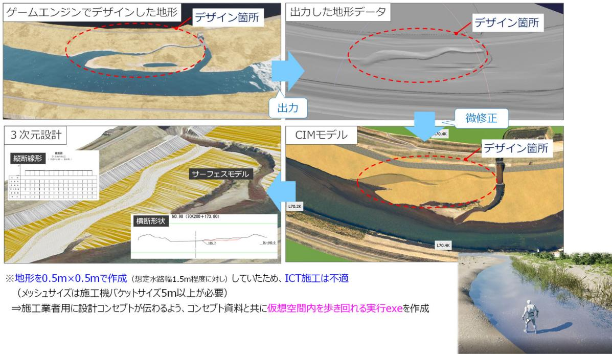
図3-9 3次元モデルによるICT施工（川内川の事例）
