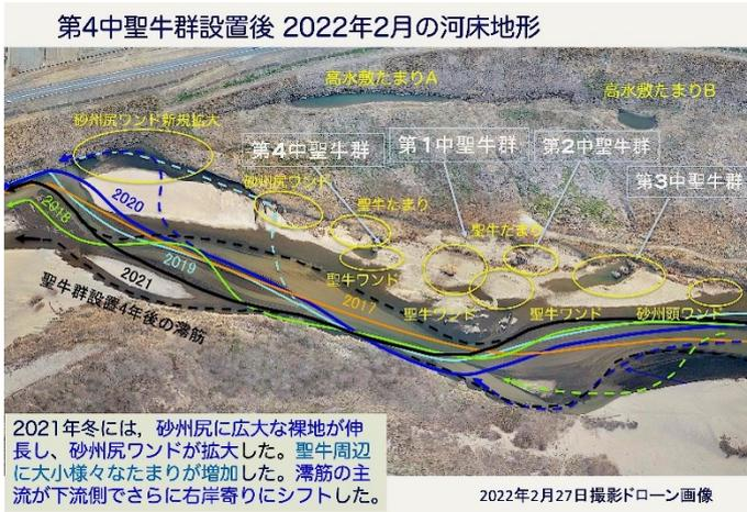
図-5 中聖牛群(全12基)設置後の滞筋の変化
