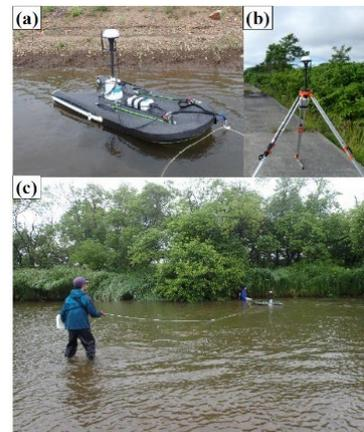
図-2 使用機器。(a) ADCP SonTek River Surveyor M9, (b) RTK-GPS型PCMモジュール, (c) 計測状況
