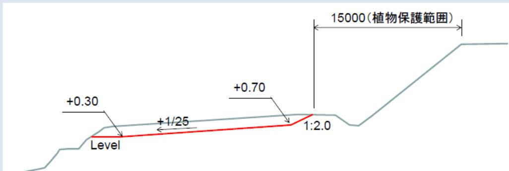
図 3.2-24 寄洲切下げ箇所の標準断面図
