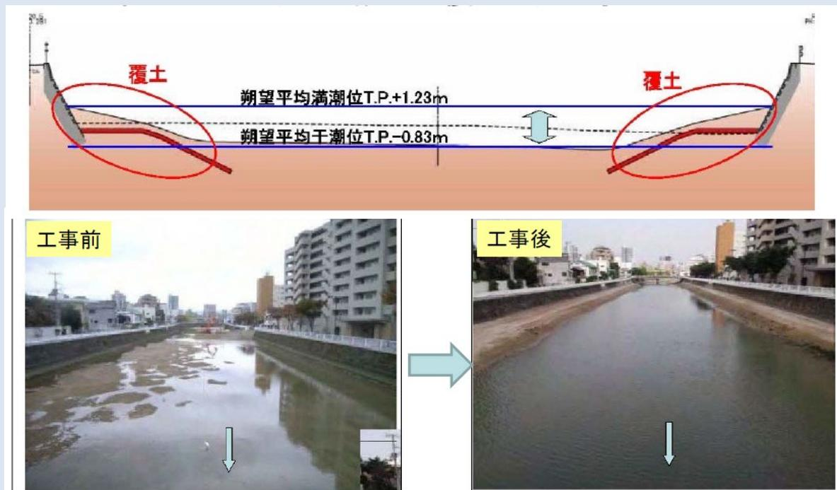
図 3.2-14 根継護岸に盛土し、干潟のある水際線を形成
