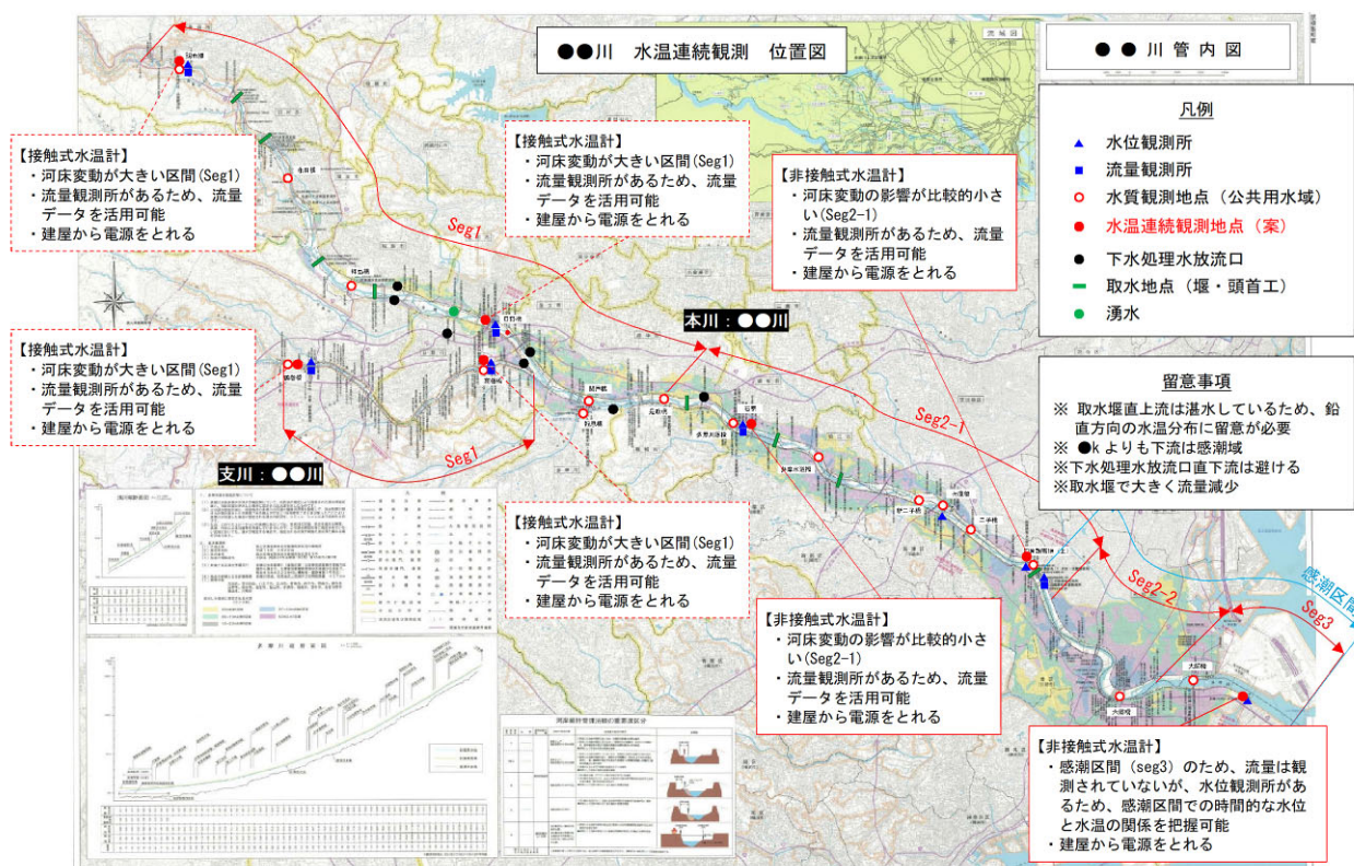
図－3 水温観測計画における機器配置イメージ (個別水系)
