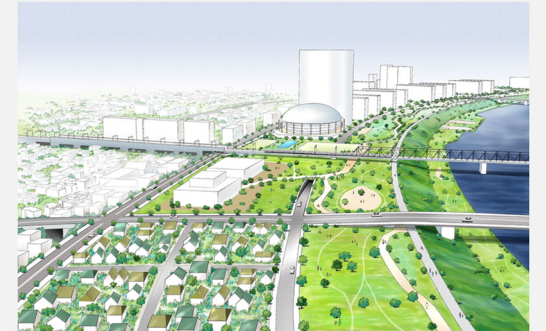
図三 橋梁等の新設・改築および高規格堤防整備と連携した高台化
