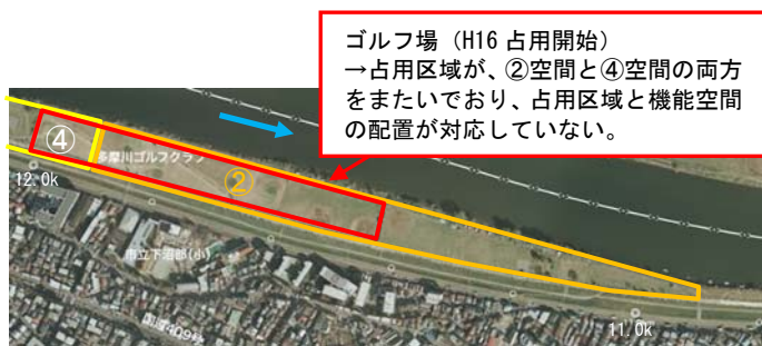
図-3 占有区域と機能空間の配置が対応していない ②空間・④空間の例（11.8k 右岸付近）
