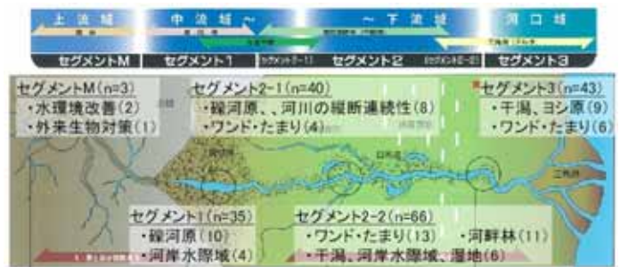
図 - 4 整備手段の縦断的な配置
