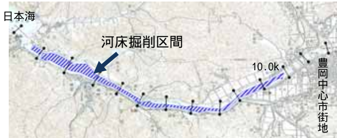
図 - 2 河床掘削実施区間（下流）
