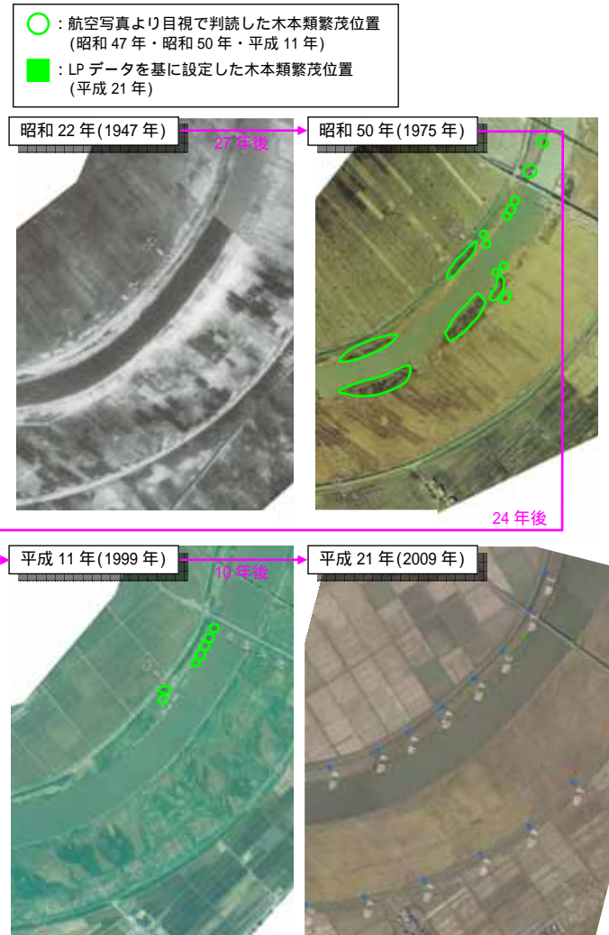
図-7 岩木川における高水敷 樹木侵入状況の経年変化
