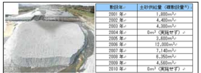
図 - 12 土砂供給の様子と年別供給量
