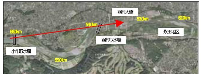
図 - 11 永田地区と土砂掘削箇所及び置き土の位置
