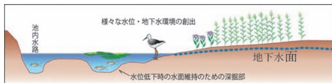
図－5 水路に接続した水面
