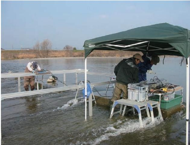
写真-4 スリット部流速観測状況
