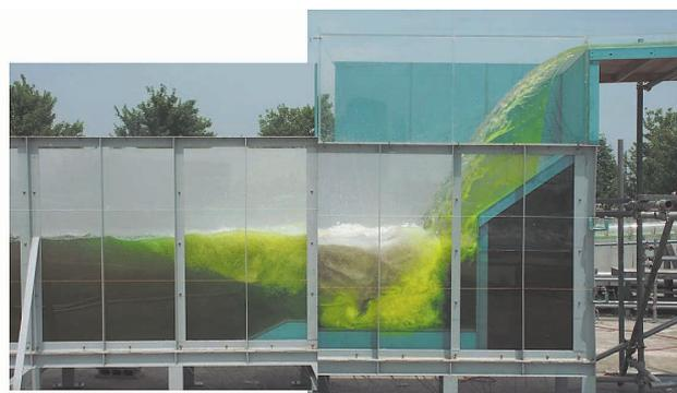
写真-2 左岸24.0km 付近、 $1\text{m}^3/\text{s}/\text{m}$  流下時の状況
