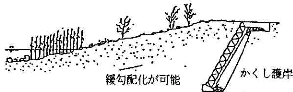
図-3 かくし護岸による自然河岸の演出
