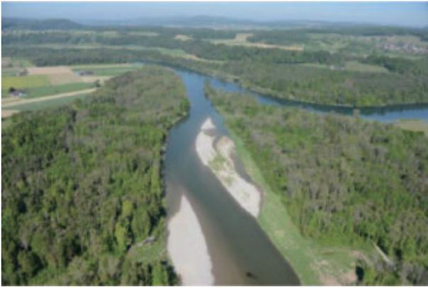
図6 トウル川河口(手前)の自然再生<sup>12)</sup>より(解説)低水護岸を撤去することで、河原などの自然な氾濫原を再生している。奥はライン川
