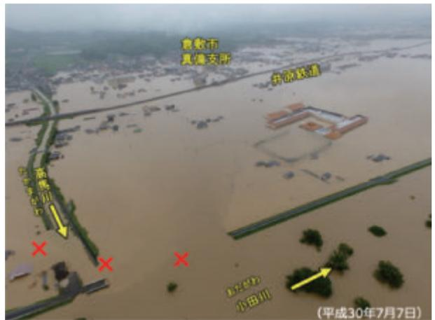
写真1 河川決壊箇所(小田川・高馬川合流点)
