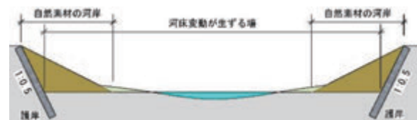
図-3 低水路幅の拡幅イメージ(出典:多自然川づくりポイントブックⅢ H20/リバーフロント整備センターを基に一部加筆)
