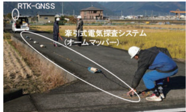
図 11. 牽引式電気探査の実施状況
