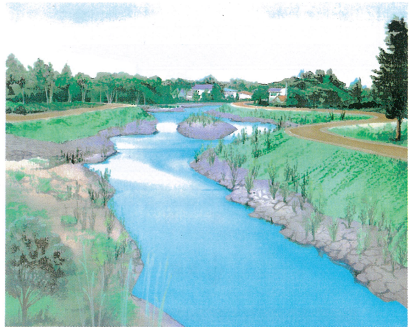
フラクタルにより水際線と柳技工を配置した護岸
