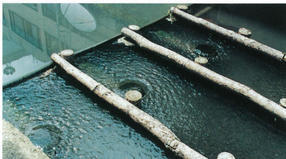
写真1 栃木県県庁堀における実験 (浄化水が噴き出ている。写真左上、上流部分との水の透明感の違いに注目)
