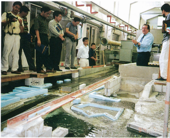
写真11 チューリッヒ工科大学における河川模型実験
