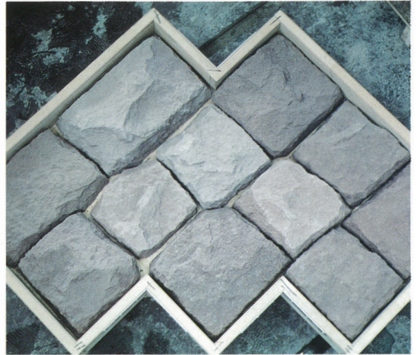
写真-2 自然石試作の型どり
