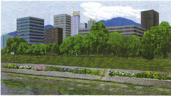
写真—4 写真—3の護岸に小段を作り、護岸の一部を張芝堤防とし、また小段に植栽し、河岸に植樹したものである。
