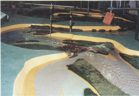
ドイツ アーヘン工科大学における模型実験装置 (実際の地形を模型で表現)
