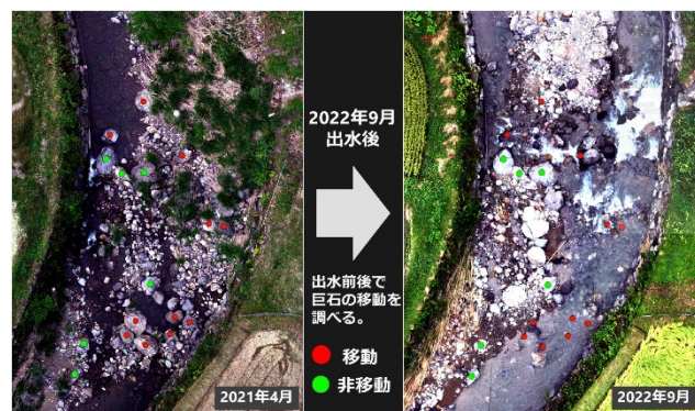
図 1 2022 年出水前後の巨石の移動状況
