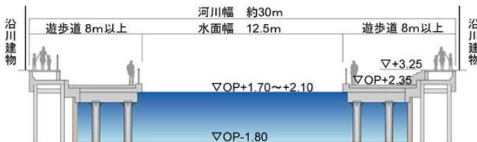
図 3 河岸エリアの空間構成
