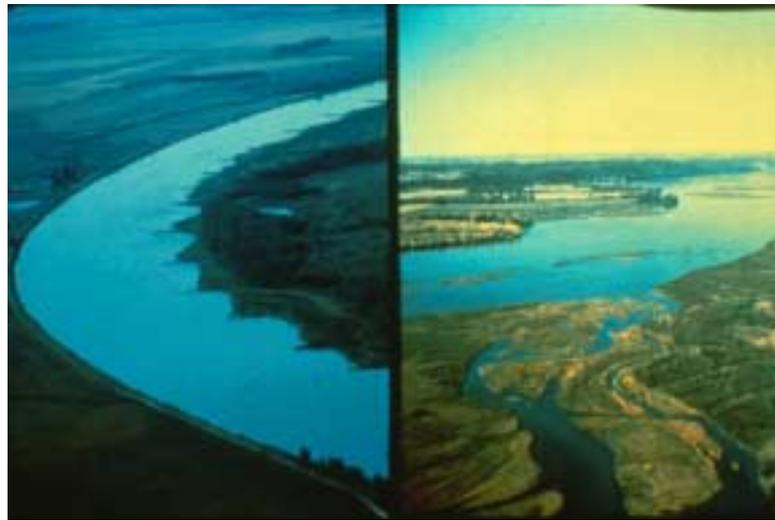
運河化される前(1830 年代)の写真(右)と運河化された後(1970 年代)の写真(左)、こちらの写真には、翼堤(wing dike)が確認できる。
