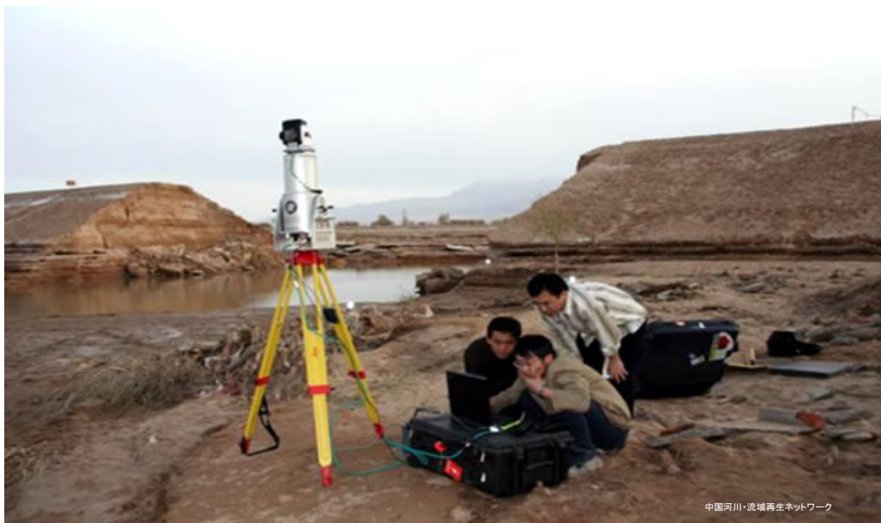
レーザースキャン技術による河川測量調査（中国）
