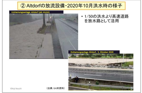
ステルタに洪水を放流する。レベル2として 1/50、620m<sup>3</sup>/s を超えると、さらに高速道路を放水路として使って、洪水を下流に流す。レベル3になると、高速道路でも氾濫水を流しきれないため、右岸側の住家が少ない地域に氾濫水を流す。ただし、鉄道敷や中小河川の堤防で氾濫水が止まるので、市街地は守られます。
