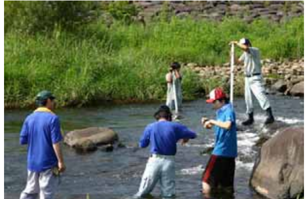
浮子を使用して、流速を測定し概略の流量を算出。普段歩かない川底をよろけながら歩く。
