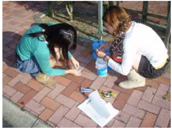
パックテストによる水質調査。今回はCOD、アンモニウム態窒素、亜硝酸態窒素、硝酸態窒素、リン酸態リンの測定を行った。
