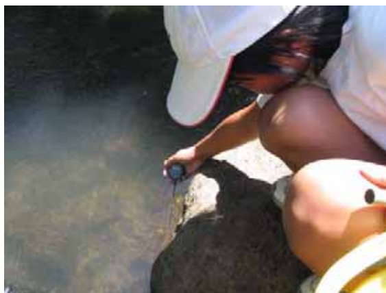
デジタル水温計で、生物の生息要因の水温の測定
