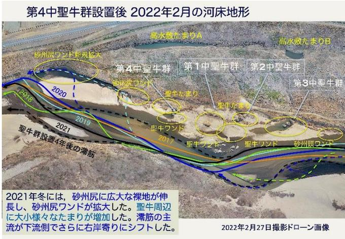
図-5 中聖牛群(全12基)設置後の滞筋の変化
