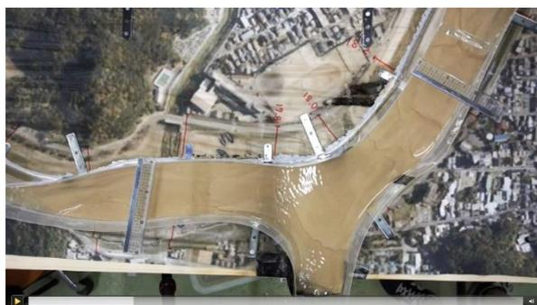
図-1 放水路分派点を再現した 1/1000 の水理模型。画面下への分岐が放水路、左端が狭窄部に当たる。
