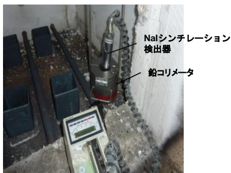
図-5 鉛コリメータを用いた空間線量率測定の様子
