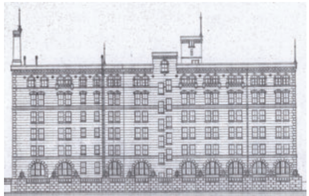
東株ビルディング竣工当時の北側立面図 基壇部の上に照明器具が整然と立ち並んでいる 横河建築設計事務所所蔵
