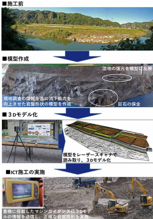
図-9 施工の流れ（模型から ICT 施工）
