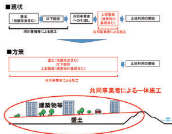
図5 共同事業者による一体施工のイメージ
