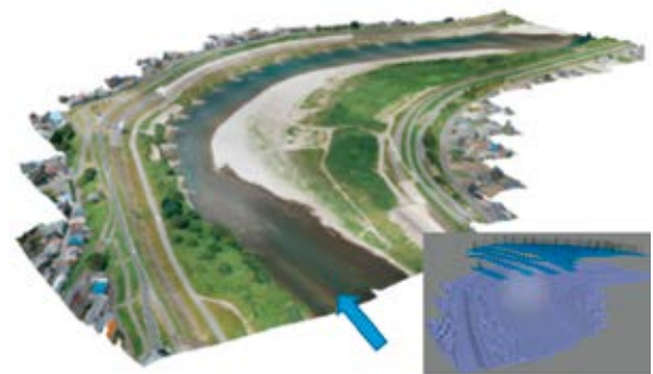
図 2 UAV-SfM/MVS による地形モデルの例（長良川）
