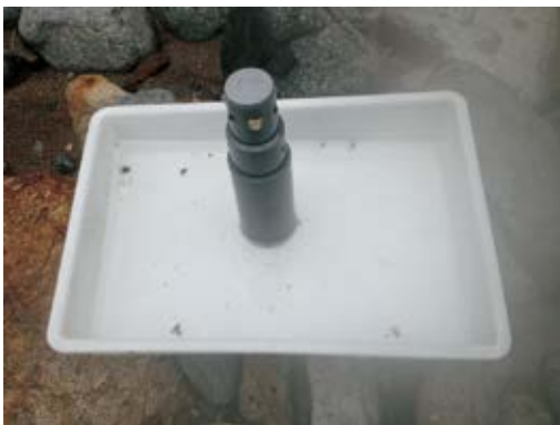
写真1. 紫外と白色LEDの自動点灯防水型照明装置を使ったパントラップ
