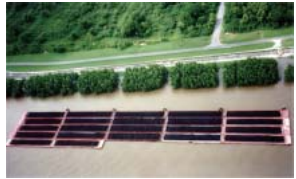
図-3. ミシシッピ下流部での平底荷船の編成 (最大横5列, 縦5列)
