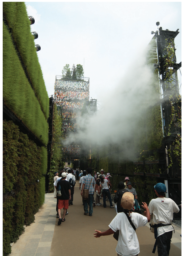
水のループの入り口に高くそびえる緑化壁「バイオラング」 (ときどき霧が噴射され涼を維持する)
