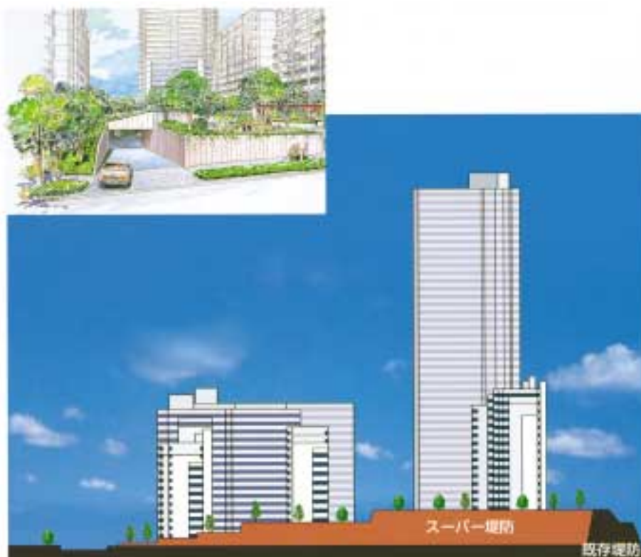
図 - 3 スーパー堤防の断面形状と地下駐車場のイメージ
