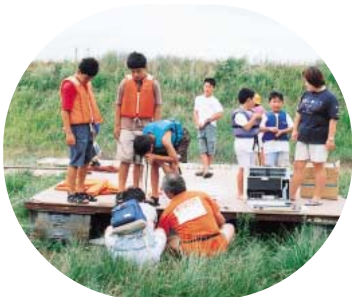
写真 - 1 北上川健康診断 - 透視計による水質の調査
