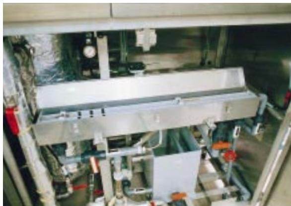
図 - 4 ウナギセンサーの測定槽の写真
